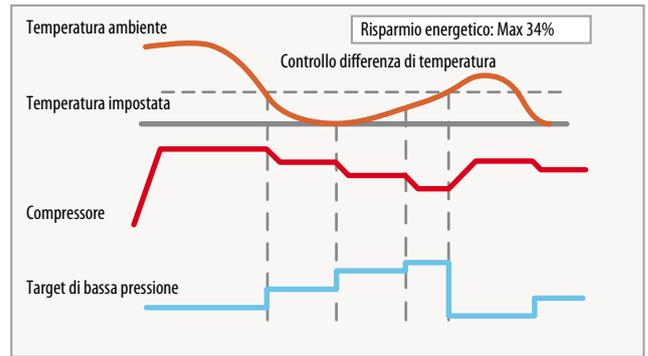
Con il nuovo VRF-T la pressione target del refrigerante da mantenere non è costante, ma si adegua proporzionalmente alla differenza di temperatura presente nell'ambiente e la temperatura desiderata. Questo permette ai compressori Inverter di modulare i giri senza mai spegnersi esprimendo così il massimo della loro efficienza per un risparmio energetico globale di funzionamento.
