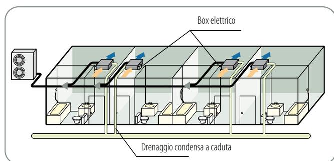
Il box elettrico e la pompa di drenaggio condensa possono essere installati su entrambi i lati dell'unità, mentre l'aria d'ingresso penetra attraverso la parte inferiore o posteriore.
