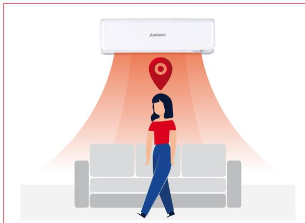
Quando il sensore rileva che nessuna persona è presente nella stanza, l'unità riduce automaticamente la potenza erogata a un livello moderato dopo circa 15 minuti; tornerà al normale funzionamento una volta che le persone rientrano nella stanza.
