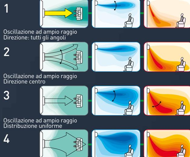
Tale programmazione, selezionabile da telecomando, permette, con un solo pulsante, di attivare tre flussi d'aria indipendenti generando una brezza uniforme che raggiunge ogni punto della stanza.
