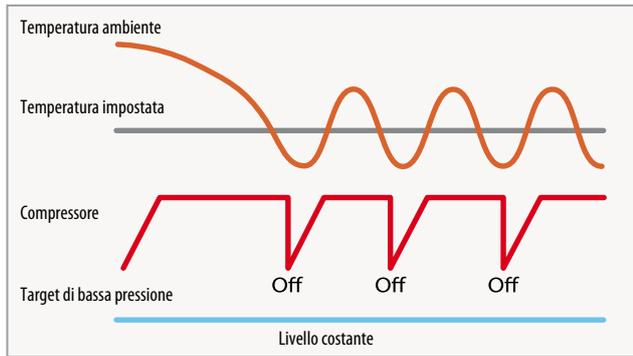
In un sistema tradizionale la pressione target del refrigerante da mantenere è costante. Quando la temperatura della stanza raggiunge quella impostata dall'utente, il compressore è costretto a diminuire e aumentare i giri con cicli di on-off che ne pregiudicano l'efficienza globale e il rendimento.
